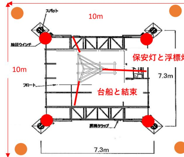
夜間および現場作業の休止時は三又櫓およびボーリングマシンを台船に結束し、転倒・飛散防止策を取ります。注意喚起のため、台船に保安灯の設置、周囲に浮標灯の配置を行います。
